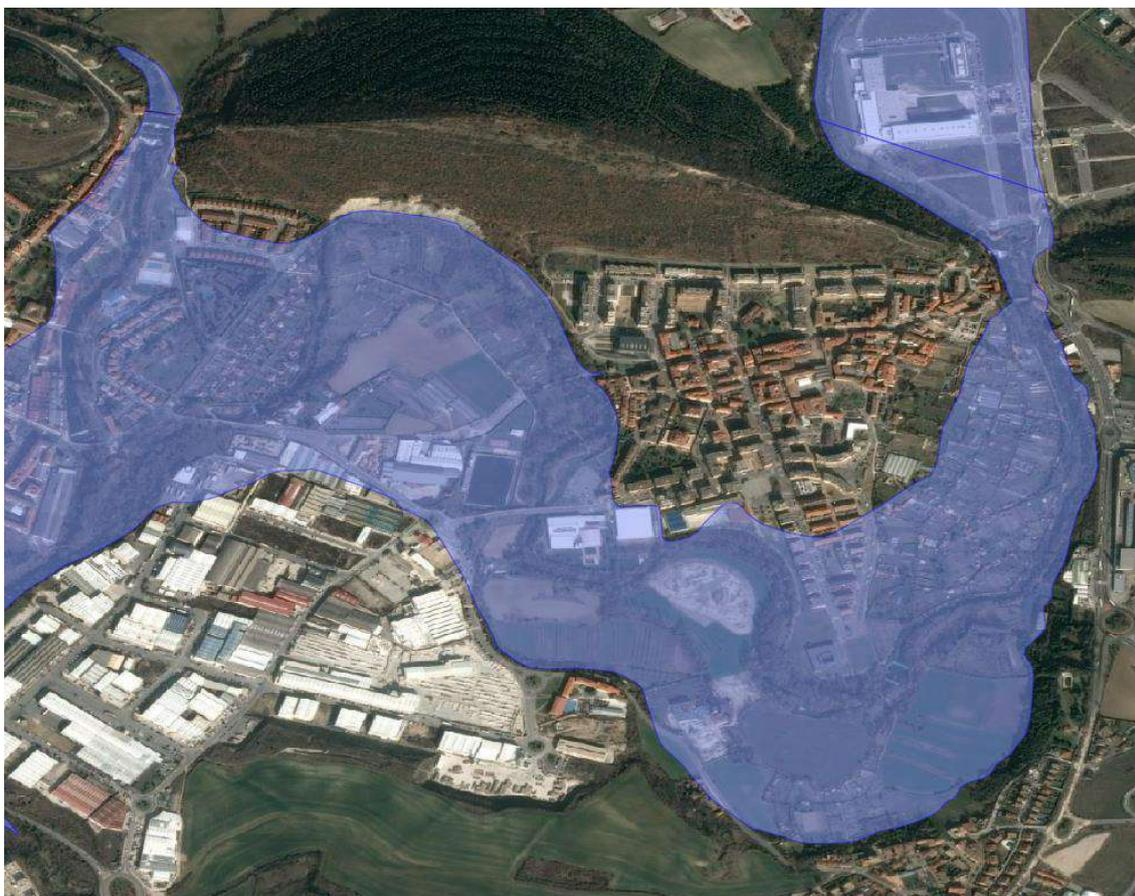
**Figura 14.** Área de inundación para una hipótesis de rotura de la Presa de Eugi a la altura del núcleo urbano de Huarte/Uharte.
